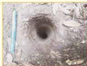
ボーリングコア試料採取風景。人力で8m掘削した。
