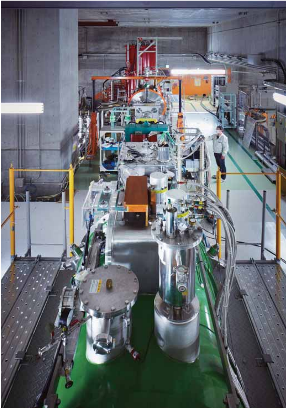
SHARAQ（シャラク）に短寿原子核ビームを供給するOEDO（オーエド）ビームライン
