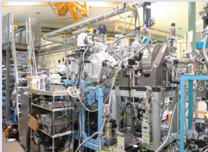
スペクトル化学研究センターのビームラインにおける X 線磁気分光装置
