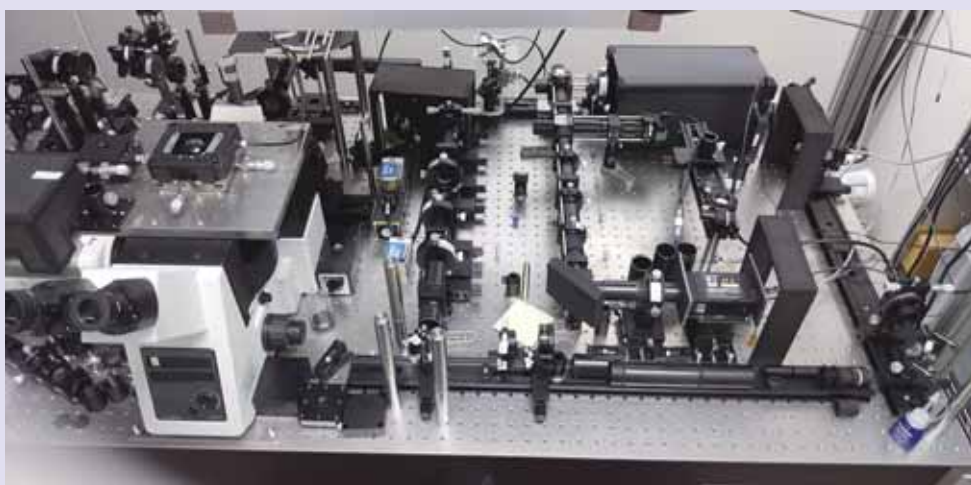
タンパク質分子モーター1分子の高速高分解能計測のために開発した顕微鏡
